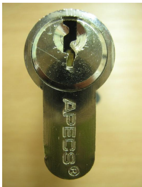
Рис. 6. Следы на торцевой части цилиндрического механизма, образованные при применении штатного ключа
