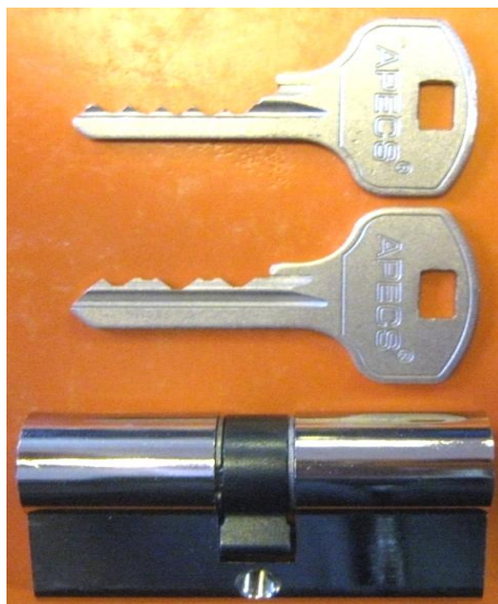
Рис. 5. Цилиндрический механизм замка (внизу), штатный ключ к нему (посередине), бамп-ключ (вверху)
