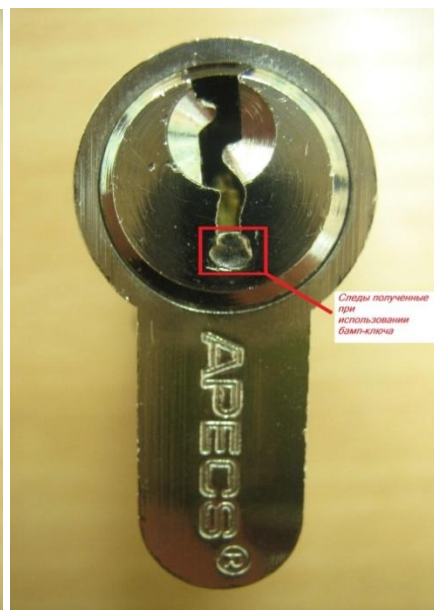
Рис. 7. Следы на торцевой части цилиндрического механизма, образованные при применении бамп-ключа
